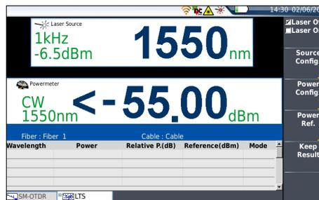
Integrierter Leistungspegelmesser und Laserquelle
