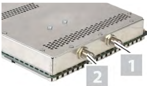
Bild 4: Tuner mit DVB-T/T2/C Signal verkabeln
