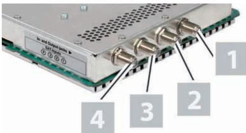
*Bild 2: Eingangsbuchsen mit SAT-ZF verkabeln*
